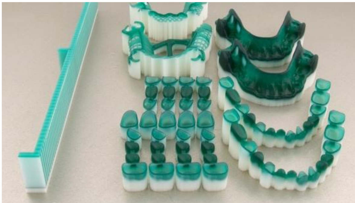
Рис. 2.23. Изделия, полученные с помощью технологии многоструйного моделирования
