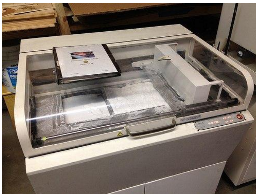
Рис.1.3. 3D-принтер модели Z402 от Z Corp
