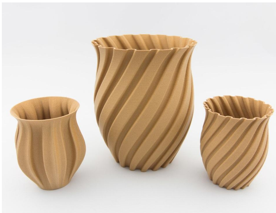
Рис. 2.18. Модели, полученные из ДПК-филамента
