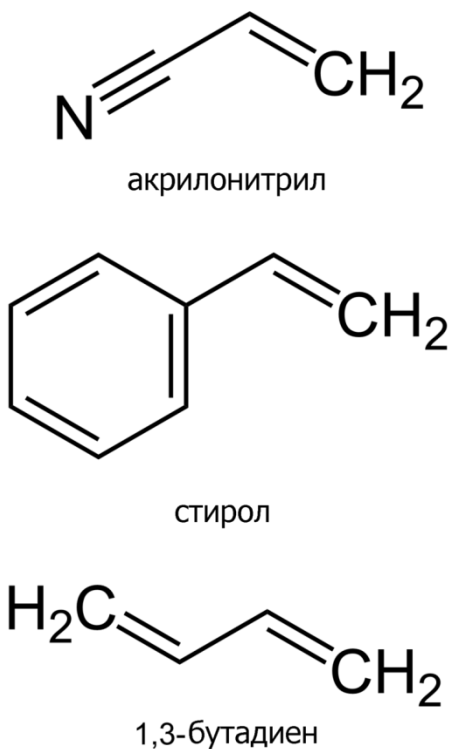
Рис. 2.3. Мономеры для синтеза АБС-пластика
