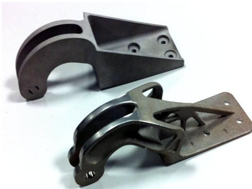
Рис. 2.28. Изделия, полученные по технологии прямого лазерного спекания
