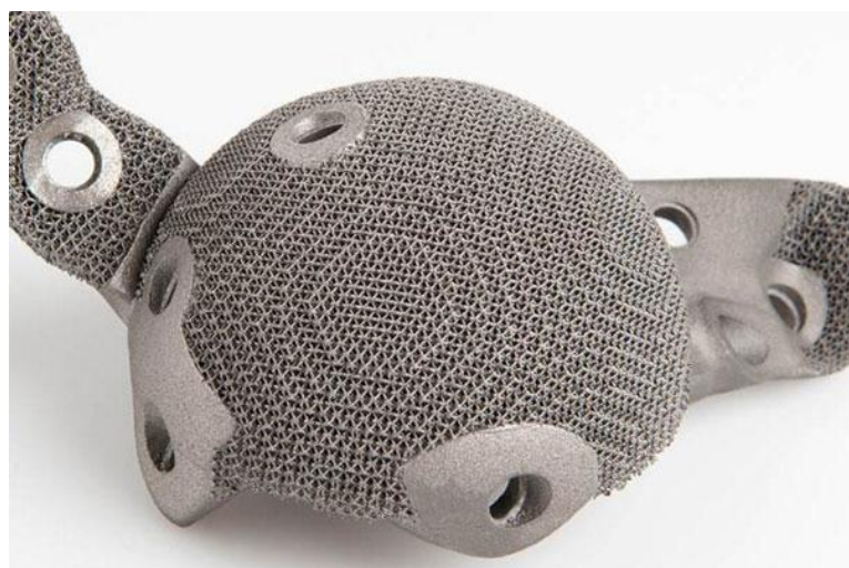
Рис. 2.33. Изделие, полученное по методу SLS
