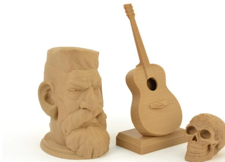
Рис. 2.19. Модели, полученные из филамента VambooFill
